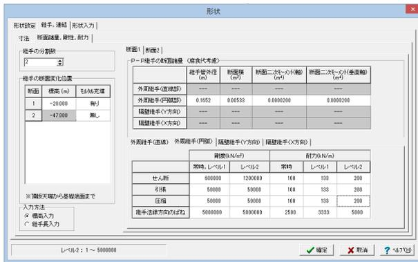
①「形状」をクリックし、「継手、連結」タブを選択、「断面諸量,剛性,耐力」タブを選択し、左図に従って断面1の値を入力します。
