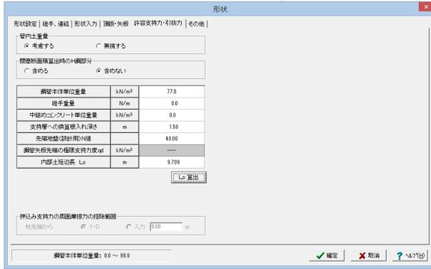
⑥ 「許容支持力・引拔力」タブに切り替え、左図に従って数値を入力し、Lo算出ボタンを押します。
