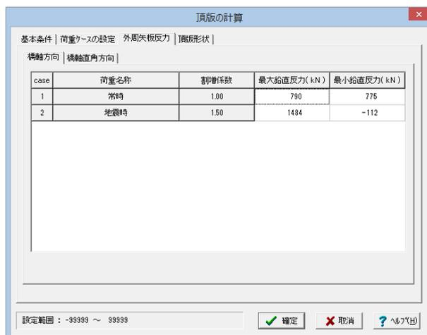
①「外周矢板反力」タブに切り替え、左図に従って橋軸方向の値を入力します。
