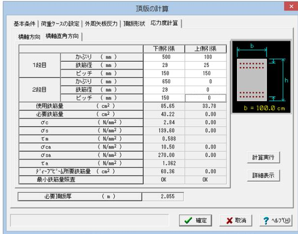
②左図に従って橋軸直角方向の値を入力します。
