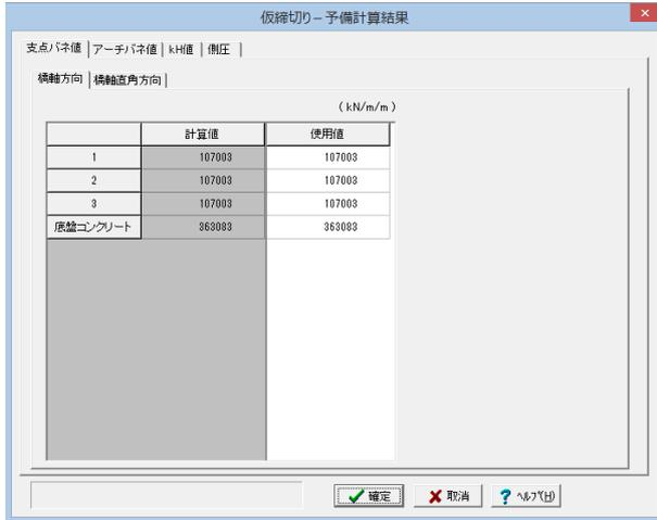
画面左の仮締切り 予備計算・結果確認をクリックします。支保工および低盤コンクリートバネ値、水平方向、地盤反力係数、側圧の計算を行い、結果が表示できます。使用値欄で算出された値を変更することができます。
