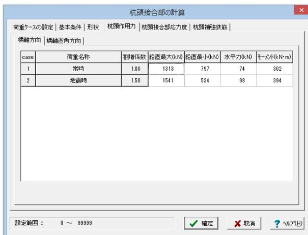
「杭頭作用力」タブに切り替え、左図に従って橋軸方向、橋軸直角方向の値を入力します。
