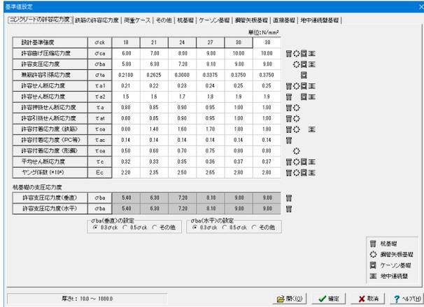
コンクリートの許容応力強度、鉄筋の許容応力強度、荷重ケース等の共通データ、および各基礎の諸数値を設定します。
