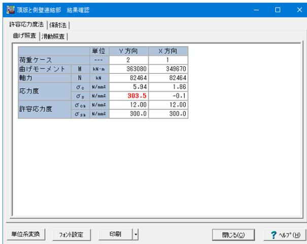
頂版と側壁連結部の許容応力度法による解析結果です。
