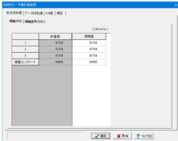
支保工および底盤コンクリートバネ値, 水平方向地盤反力係数, 側圧の計算を行い、結果を表示します。使用値欄で算出された値を変更することができます。既に予備計算を実行している場合、再計算を行うか確認のメッセージが表示されます。再計算を行う場合は[計算実行]を、行わない場合は[取消]を押してください。なお、データの修正を行った場合は、必ず実行してください。
