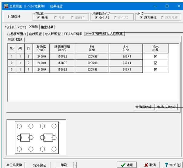
**水平方向押抜きせん断照査**
