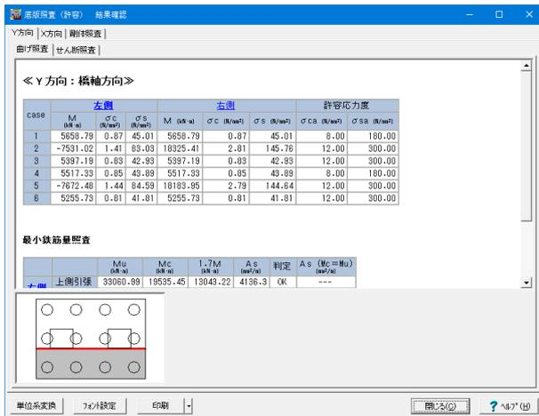
計算方向ごとに曲げ照査、せん断照査結果を表示します。赤文字は許容値を超えていることを示しています。
