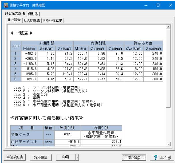
部材計算の側壁水平方向の結果を表示・描画します。
