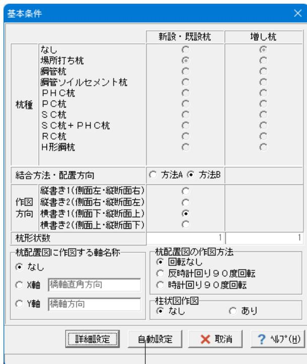
図面作成モードの基本条件の入力および作図対象（杭種・杭形状数）の表示・変更を行います。
