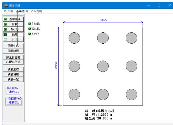
「図面生成」をクリックすると鉄筋情報生成・図面生成が実行され図面確認画面が起動します。
