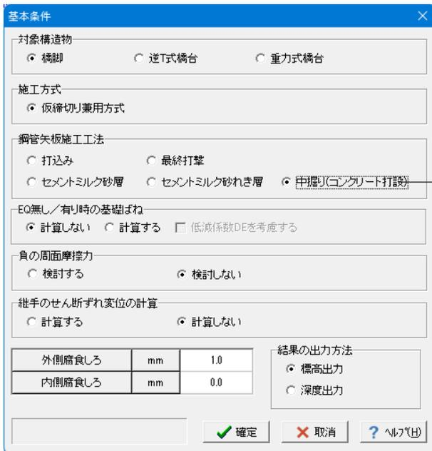
鋼管矢板施工工法「中掘り(コンクリート打設)」が選択可能になりました。
