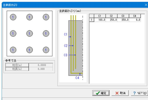
主鉄筋かぶりおよび底面鉄筋かぶりを「外形から鉄筋中心までの距離(単位:mm)」で指定します。ガイド図を参考に入力してください。なお、「新設・既設杭」と「増し杭」の内容は同じですが、「場所打ち杭」と「場所打ち杭以外」で設定内容が異なりますのでご注意ください。
