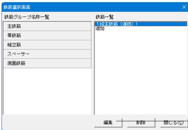
鉄筋情報の詳細入力で配筋する鉄筋を指定するためのウィンドウで、鉄筋一覧に追加された鉄筋が配筋図に作図されます。
