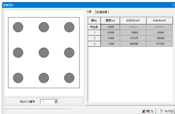
2次元解析の場合、EQ無し、EQ有り、および固有周期算定用の地盤ばね定数を算出します。
