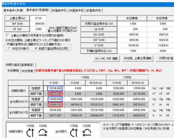
青枠のVが初期作用力と全作用力タイプIが異なった値を設定した事で、赤枠の底面下面の初期作用力(24977.320kN)と全作用力タイプI(25043.320kN)となっています。
