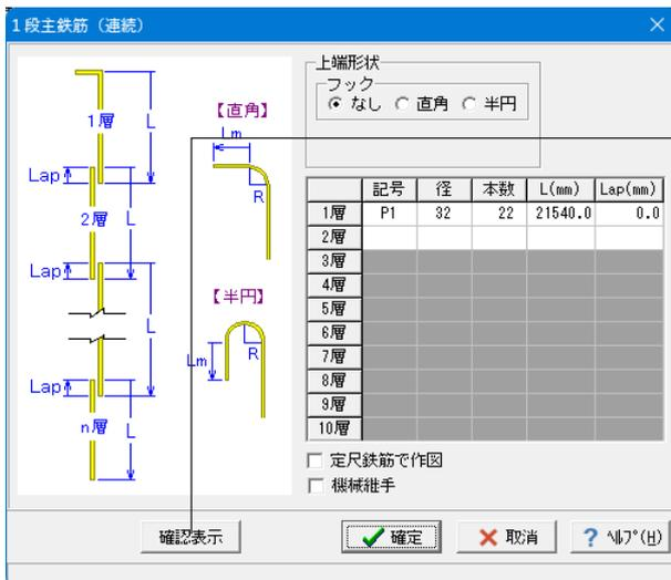
ここでは主鉄筋（連続）の情報（1～3段すべて共通）を設定できます。本入力は継ぎ手位置が同じとなる連続継ぎ手で主鉄筋を配置する場合に使用してください。
