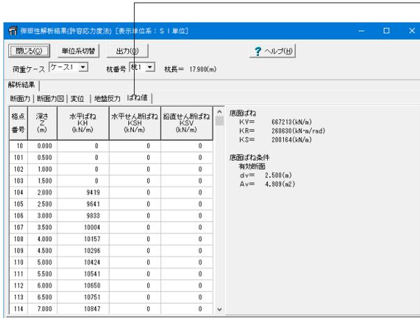
4-3 許容応力度法\_フレーム解析結果 (許容)
