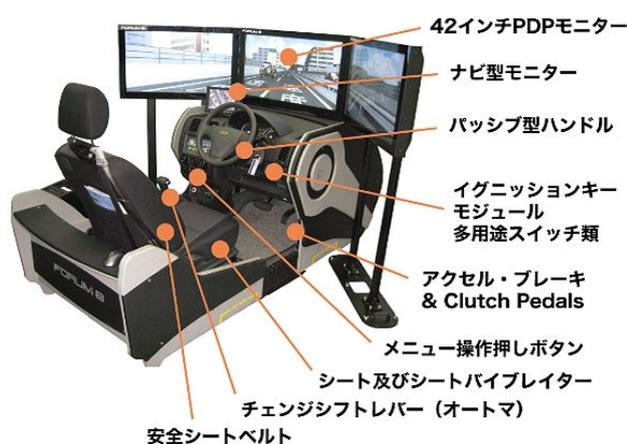
図 1 3 画面ドライビングシミュレータ装置
