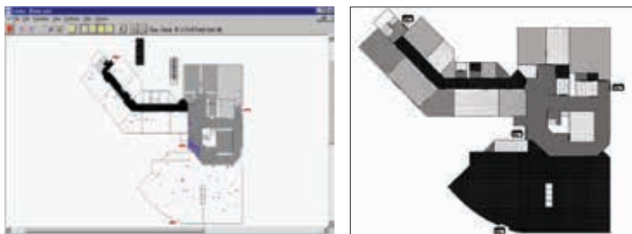
▲ 部屋と通路部の自動探知および空間グラフ生成
