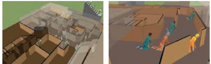
▲ SMARTFIREで予測される延焼とbuildingEXODUSシミュレーションの表示 (vrEXODUSによる煙拡散とはう占有者を示す避難シミュレーション結果)
