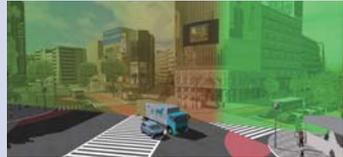
地表面や構造物および建築物などの影響を考慮し、受音面上の各受音点における音圧レベルを解析
