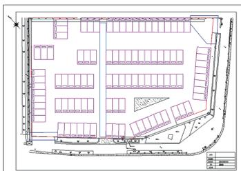
▲在新設計圖上製作外圍/通道後一次配置停車位
