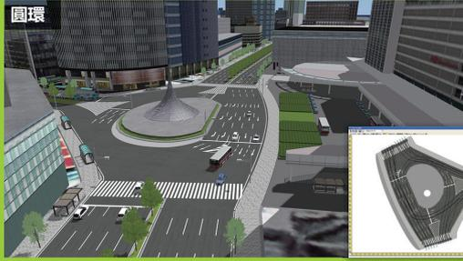
▼透過Traffic Generators(交通生成)/Flow(交通流)車種比例、時間交通量設定，可以進行交通流生成與車輛衝突控制的交通流模擬。
