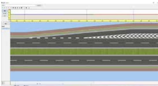
図2 道路縦断面画面での断面プレビュー
