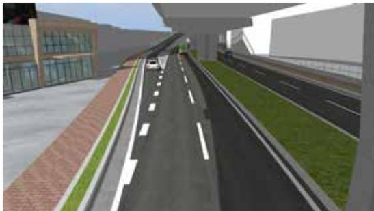
図1 分岐部の導流帯：完成形
