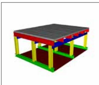
図2 支柱（くい）の敷桁基礎で検討したモデル
