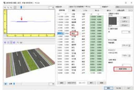
図4 基とする片側2車線の道路断面
