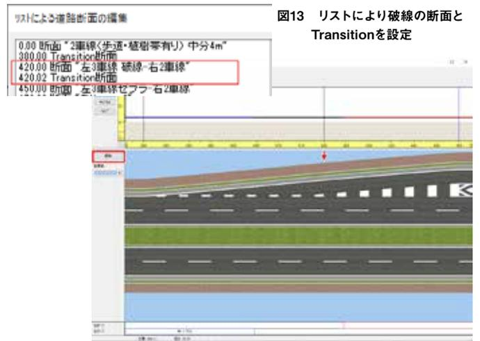
図13 リストにより破線の断面とTransitionを設定
