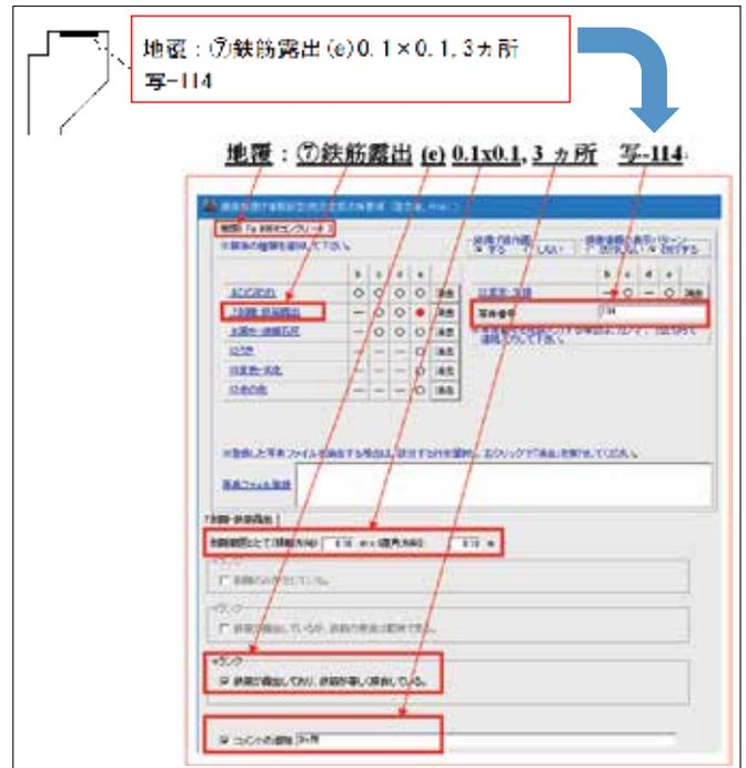
図2 損傷要素（文字列）から損傷情報変換
