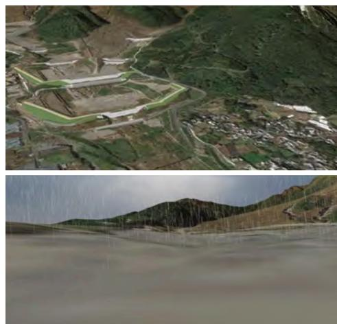
図8 UC-win/Roadで可視化した土石流対策施設の配置状況(上)や土石流の流動状況(下)
