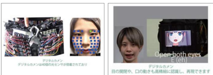
デジタルカメンは、「仮の顔」として好みのCGキャラクターを表示する軽量薄型有機ELディスプレイを搭載し、裏面に装着者の表情の変化を測定する反射型フォトセンサアレイ40個を組んでいる。表情の変化に伴う顔の各部位における皮膚の微小変位をセンサアレイで計測し、サポートベクターマシンを用いた表情認識モデルを構築する事で、装着者の表情および口の動きをリアルタイムでアバターの表情へと反映させる。実験では、平均79%の認識精度を達成し、被験者からは自身の表情や発話が違和感なくアバターの表情に反映されたという評価が得られた。
