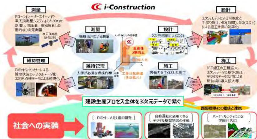
図2 i-Constructionの推進に向けた建設プロセス全体における3次元データの連携
