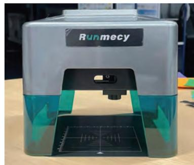
素材の表現にレーザー光で文字や絵を刻印できるデバイスです。スマートフォンで使う場合は、Bluetoothで接続し、刻印データを送信、位置、サイズ合わせ、素材に合わせてレーザー光強度を設定し、刻印。刻印できる素材は、ステンレス、木材、プラスチック、皮革、セラミック。なんとデモではクッキーにも刻印がされていました。表面が平らで、反射率が低ければなんでもできそうです。
