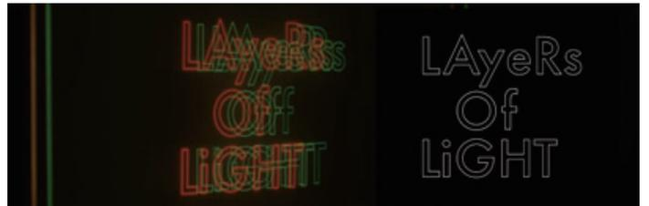
蛍光材料を含んだ透明スクリーンで構成された層構造のディスプレイにプロジェクションした映像が、蛍光材料の物性である励起・反射により、各層に分離して表示。赤・緑・青を分離することで最大3層の立体表示が可能で、スクリーンを造形したり、動かすことで多様な表現が可能に。単に装置の発明だけでなく、ディスプレイでの表現手法を、映像作家でもある作者が開発し作品化している点が特徴。
