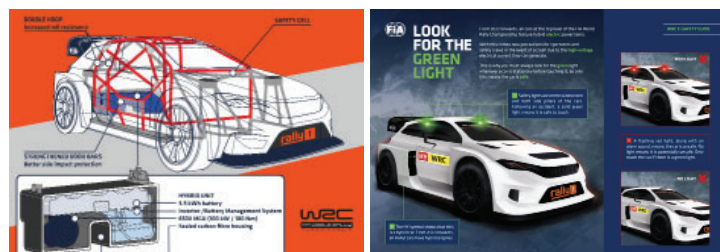
ハイブリッド搭載のラリー1。高電圧のため緑ランプ点灯時以外は接触厳禁だ。
