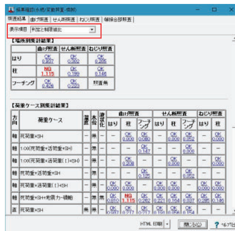
図2 永続/変動照査－橋脚－照査結果画面
