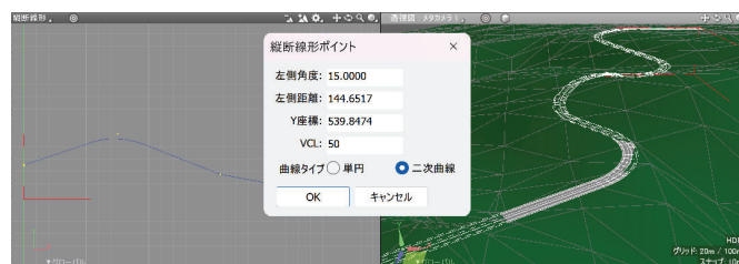
図3 縦断曲線設定による地形の勾配に合わせた道路線形の生成
