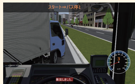
障害物などに衝突すると警告が出る
