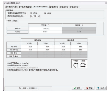
図3 橋脚設計時の基本条件 (落橋防止)
