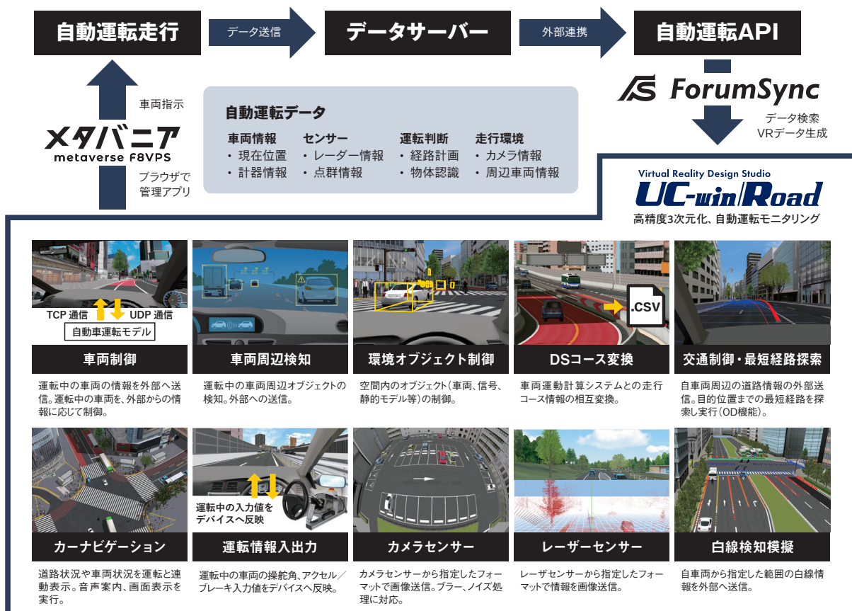
図2 自動運転管理プラットフォームのシステム連携イメージ
