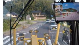
デモ走行の様子。除雪グレーダ内に設置されたモニタで、実際の走行位置と連動したVR空間の映像が表示されている
