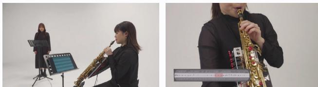
RoboSaxはサーボモータで演奏を自動化した楽器で、楽譜なしでも演奏可能。Melody Slot Machineは、類似構造のメロディを入れ替えて楽しむインタラクティブ音楽システムで、音楽構造の分析にAIを活用。
