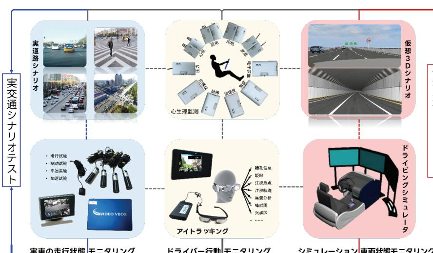
実交通データと仮想シミュレーションを統合し、運転行動と車両状態を多角的にモニタリングする研究プラットフォーム
