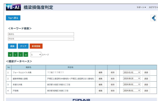
図5 点検データのクラウド管理
