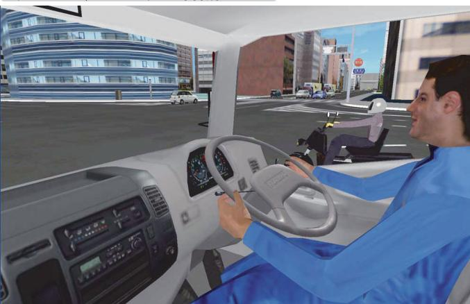
自動車性能プロファイル対応交通シミュレーション、マニュアルドライブシミュレーション(3Dコックピット対応)
