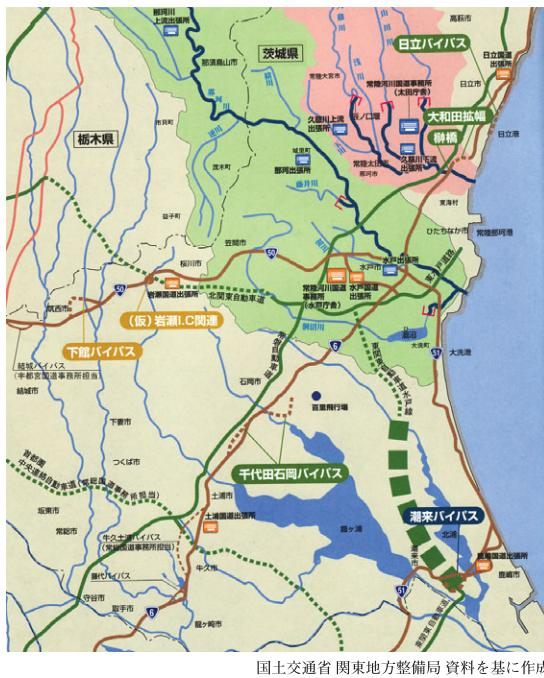
号関連の事業として、最も規模の大きいのが「日立バイパス」。日立市には国道6号と同245号が通っており、これらが生活道路や市外との連絡道路、通過交通道路としての役割を担ってきた。その結果、もたらされた市内における渋滞の解消と交通事故減少を図るべく、通過交通などを分散させるためのバイパスが海岸部に計画されたもの。事業化されている延長約4.7kmのうち、約2.6kmが01年以降段階的に暫定2車線（完成は4車線の予定）で供用されてきている。今年度は旭高架橋の上部工事や護岸工事などが行われる予定という。
