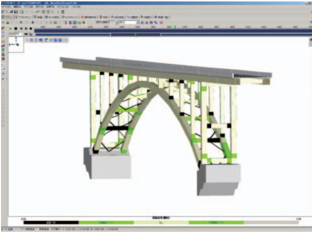
(a) 最大圧縮ひずみによる損傷状態 (■ \epsilon'_s \geq 2\epsilon'_y 、■ \epsilon_s \geq \epsilon_y )
