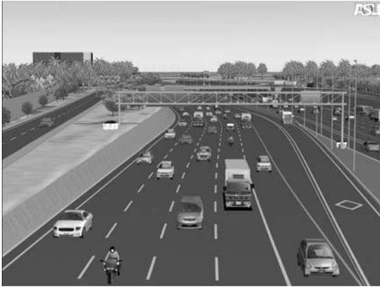
UC-win/Roadによって作成されたフェニックス市街地にアクセスする高速道路I-10のモデル。実際のラッシュ時の交通量を忠実に再現している。
