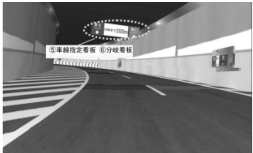
車線指定看板で行き先地名と色をリンク 分岐看板で分岐点までのカウントダウンを表示
