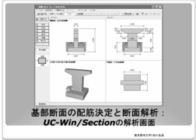
条件がすべて異なる断面が与えられる。続く「課題2：RC橋脚の耐震設計（その1）」では、基本的に現在の設計基準を満たさない既設橋脚となるよう課題を設け、許容応力度法および地震時保有水平耐力法による耐震設計計算を行う。最後に「課題3：RC橋脚の耐震設計（その2）」として、今度は設計基準を満たすように配筋を変更し、再度、地震時保有水平耐力法により耐震設計計算を行う。受講生にはこれら3段階の演習課題が順次設定され、それぞれについてレポートの提出が求められる。
