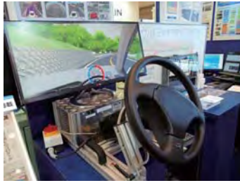
▲クルマの自動運転システムのシミュレーション。 左カーブ、右カーブに合わせてハンドルが自動的に回転し、道に沿って進む
