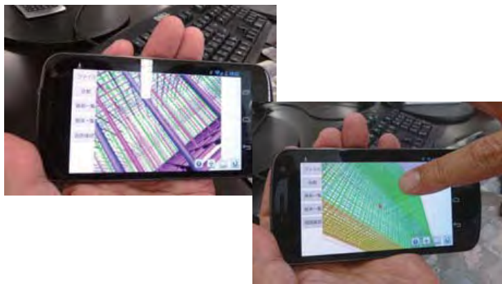
▲Android 端末上に表示された 3D 配筋図（左上）と、タッチパネルによる操作（右下）
