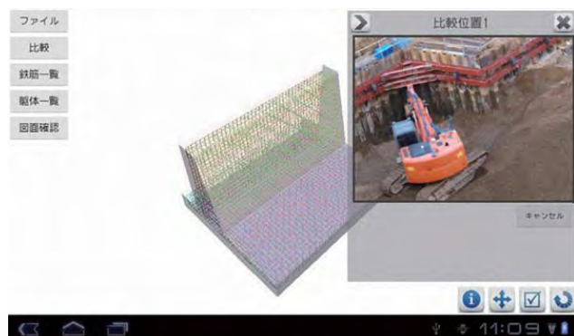
▲3D 配筋図を現場写真にひも付けて保存する機能（枠内の写真は合成です）
