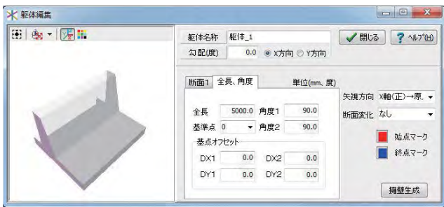
▲コンクリート躯体を一筆書きのように設計し（上段）、押し出すことで 3D モデル化（下段）することも可能
