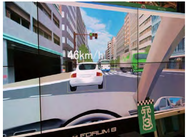
▲ドライビングシミュレーターに実装された先進運転支援システム (ADAS)。前方を走るクルマの速度が表示されている
