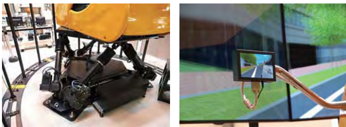
▲運転席にリアルな動きを与える6軸モーションベース（左）とバックミラーの映像を再現する小型液晶モニター（右）
