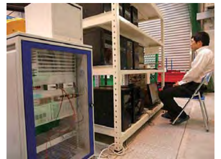
▲実車の開発にも使われる「HILS」（手前）とモニター1台ずつに割り当てられたパソコン群（奥）。操作するのは向井正和助教
