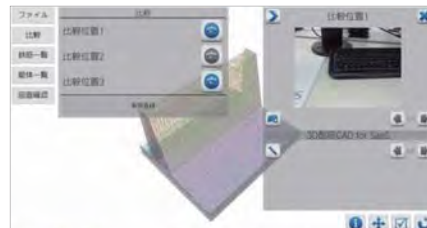
▲「3D 配筋 CAD for SaaS」の画面例。クラウド上で配筋の 3D モデルや図面のほか写真やコメントを共有し、オフィスや現場で活用できる
