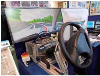
▲クルマの自動運転システムのシミュレーション。 左カーブ、右カーブに合わせてハンドルが自動的に回転し、道に沿って進む
