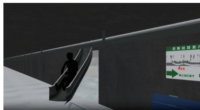
VRプログラムでは、トンネル内で火災が起き、トンネル内を移動してすべり台式非常口を使って下層階の避難道を使って避難するまでを擬似体験できる。
