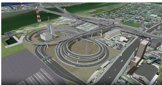
JCTは走行シミュレーションが可能。道路のレイアウトや案内標識は完成形がイメージできる正確な描写となっている。また、換気所は段階を遡って施工状況を確認することができる。
