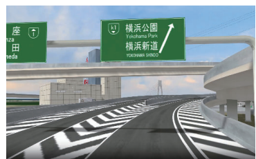
JCTは走行シミュレーションが可能。道路のレイアウトや案内標識は完成形がイメージできる正確な描写となっている。また、換気所は段階を遡って施工状況を確認することができる。
