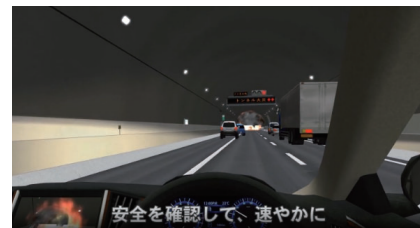
VRプログラムでは、トンネル内で火災が起き、トンネル内を移動してすべり台式非常口を使って下層階の避難道を使って避難するまでを擬似体験できる。
