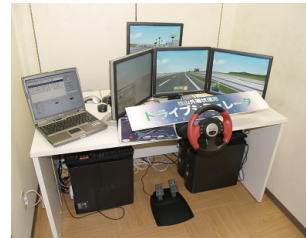
「UC-win/Road」を使用したドライブシミュレータのVR運転操作部
