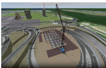
JCTは走行シミュレーションが可能。道路のレイアウトや案内標識は完成形がイメージできる正確な描写となっている。また、換気所は段階を遡って施工状況を確認することができる。
