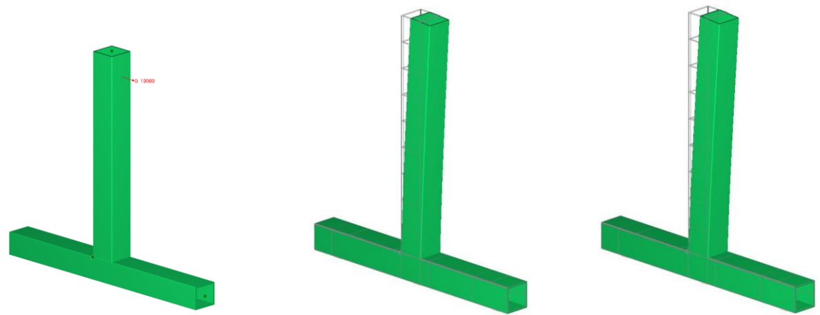
シミュレーションモデル 試験体破壊のメカニズム[完全破壊前 (8mm)～完全破壊(10mm)]
