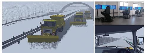
モーション装置付きの3面ディスプレイで操縦装置を構成、3台の梯子段除雪の運転訓練にも対応。
