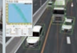
高速道路車両軌跡シミュレーション (阪神高速道路株式会社)
