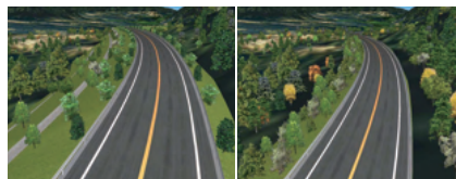
法面最小化 (対策前・対策後)
