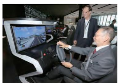
リピーターも多く、列をなすほど人気の高い大型車両のシミュレータ。大型車の先進安全技術と燃費技術を実車に限りなく近い体感で実現。モーターショーの際は2週間で約2000人が利用。
