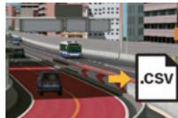
UC-win/Roadの道路データにおける道路中心線もしくはレーン中心線をCSV形式で出力。他システム側で読み込むことで、UC-win/Roadの道路を再現可能。
