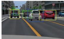
UC-win/Road内で運転中の車両周辺にある他車両や道路標識などを検知しこれらの情報を外部へ送信。オブジェクトの周りに枠線や指定した情報を表示する。
