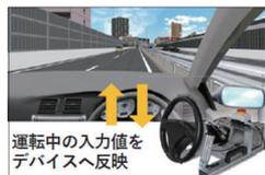
運転中の入力値をデバイスへ反映。運転中の車両の操舵角、アクセル/ブレーキ入力値をデバイスへ反映。
