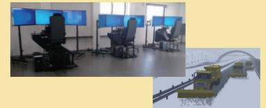
除雪車両オペレータの育成を目的として共同開発した車両操作シミュレータ。操縦装置はモーション装置付きの3面ディスプレイで構成される。3台の梯団除雪の運転訓練にも対応。
