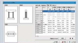
▲RC下部工の設計・3D配筋 (部分係数法・H29道示対応)
