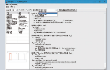
▲ラーメン橋脚の橋軸方向の保有水平耐力照査結果画面
