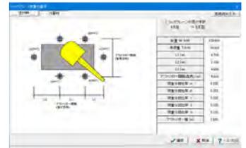
▲トラッククレーン荷重 6軸のアウトリガーに対応
