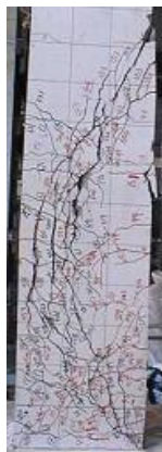
S10 試験体(曲げせん断耐力比 1.08, 曲げせん断破壊)
