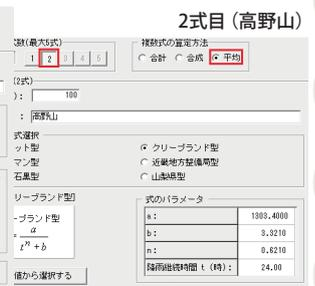
図3 平均降雨強度算出時の降雨強度式入力例(和歌山+高野山)/2
