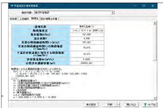
図2 簡便法のみ計算時の貯留施設結果表示例
