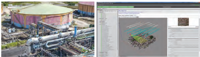
▲ContextCapture: リアリティメッシュ(写真テキスト付3Dモデル)により、現実のコンテキストを正確に反映(左)/写真から空中三角測量を自動実行可能(右)
