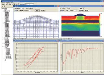
▼過剰間隙水圧比(2次元液状化解析)
