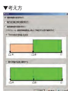
中国基準(「建築基坑支護技術規定(JGJ120-99)」など)に準拠。各掘削時ケースの「慣用法」と「弾性(支点)法」による照査に対応しており、また、掘削底面の安定照査(ボイリング、ヒーピング、バイピング、盤ぶくれ)に加えて、決定根入れ長に対する転倒照査や円形すべり法による全体安定照査を行うことが可能です。
