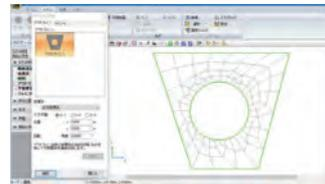
▼地盤と構造物の一体解析モデル
