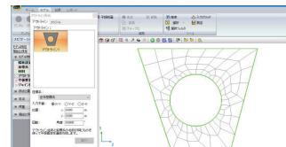
▼地盤と構造物の一体解析モデル
