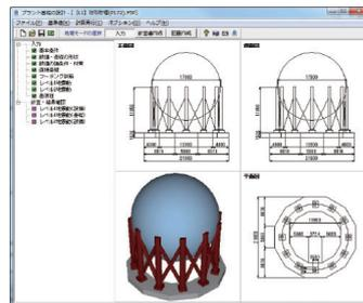
▼球形貯槽：脚柱作用力の直接指定時
